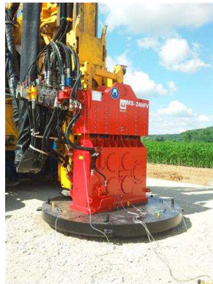
Bild 2 Links - DyStaFiT-Gerät auf den Versuchsfeldern. Rechts – Detail Platte mit Rüttler.
