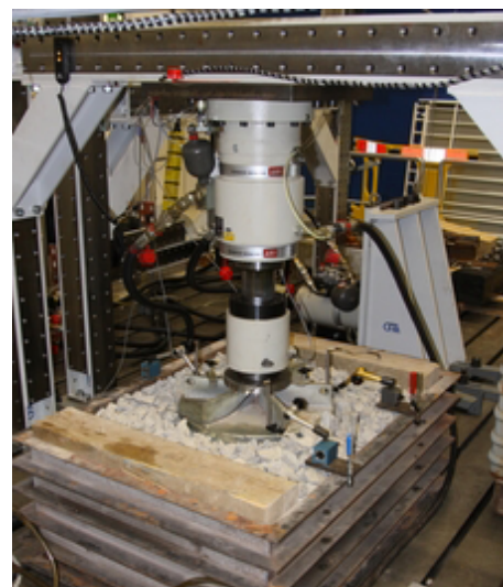
Abbildung 7: Versuch im Schotterkasten
